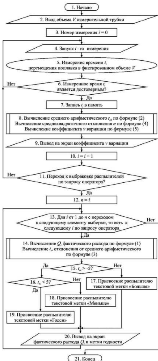
Рисунок 2. – Блок-схема алгоритма оценки качества работы опрыскивателей в полевых условиях
