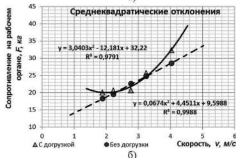
Рисунок 4. – Зависимости средних значений силы сопротивления на рабочем органе (а) и обобщенной координаты (б) от скорости орудия
