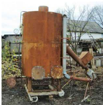
Рисунок 3. – Ферментер и установка для подачи органической массы
