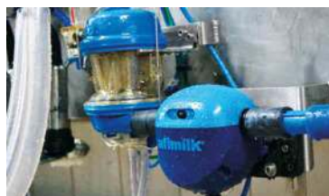
Рисунок 2. – Молокомер Afimilk и анализатор состава молока AfiLab
