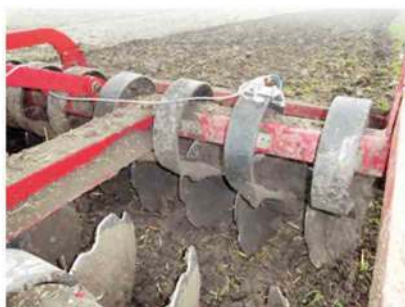
Рисунок 2. – Внешний вид агрегата с упругими стойками во время проведения экспериментов
