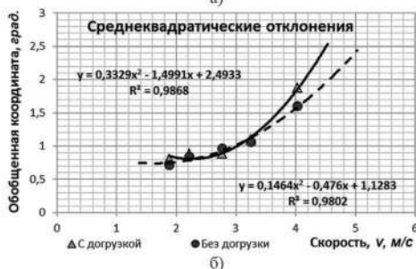
Рисунок 5. – Зависимости среднеквадратических отклонений силы сопротивления на рабочем органе (а) и обобщенной координаты (б) от скорости орудия
