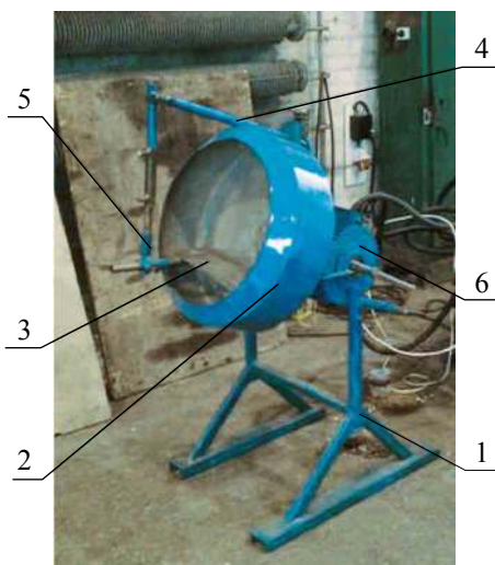
1 – станина; 2 – барабан; 3 – скатная доска; 4 – кронштейн; 5 – шарнир; 6 – механизм регулирования угла наклона барабана
