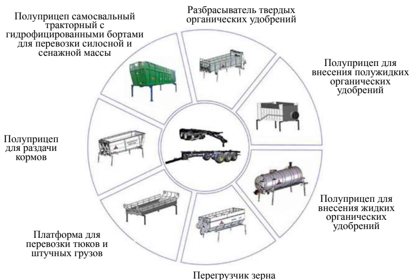
Рисунок 1. – Конструктивные схемы транспортных и транспортно-технологических систем, монтируемых на двухосные и трехосные ходовые платформы (шасси)
