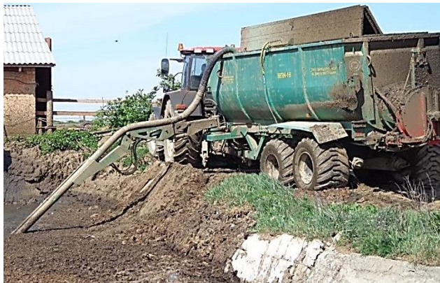
Рисунок 64 – Машина МПН-16 на загрузке полужидкого навоза
