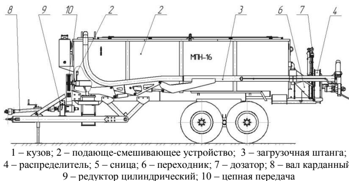
Рисунок 63 – Схема машины для внесения полужидкого навоза МПН-16 (вид сбоку)
