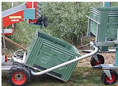
Рисунок 103 – Спуск заполненного плодами контейнера
