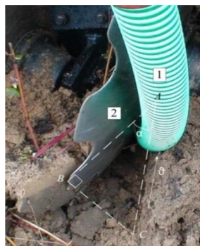
1 – разливочный шланг; 2 – сферический диск
